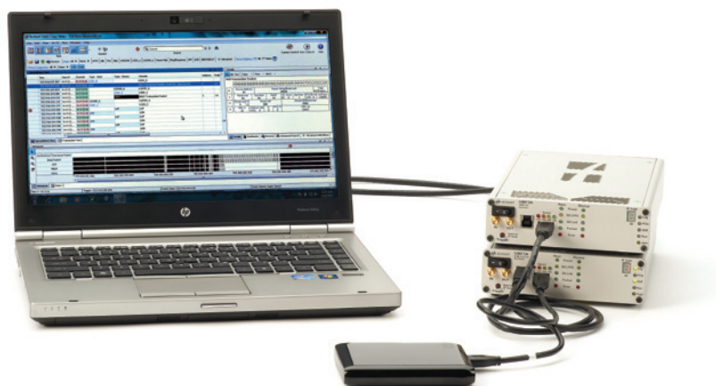
图8. U4611A 和 U4612A 通过级联作为单一系统工作, 使用一个UI来控制整个测试设置。
