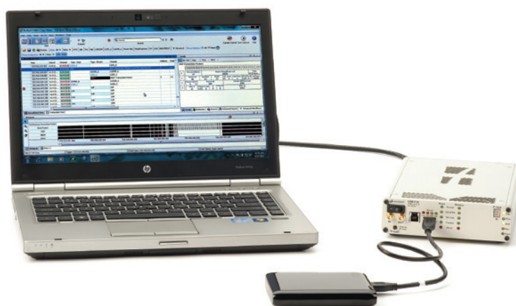
图 1. U4611A/B 分析仪以直通模式连接，并记录主机与被测器件之间交换的流量。
