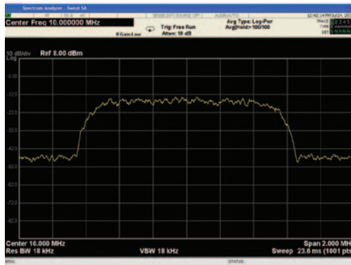
图5. DDS与Keysight Trueform技术的星座图和频谱图。图中,使用DDS和Trueform发生器生成同一个QPSK信号。两者的调制质量(EVM, 矢量幅度误差)和频谱质量相差很大(注意动态范围内的20 dB差别)。在DDS星座图中的椭圆分布点(红色)显示了抖动在调制域中作为相位噪声存在;纯噪声(高斯噪声)可使Trueform发生器的星座图点呈圆形。由DDS体系结构产生的采样抖动会导致频谱增益。
