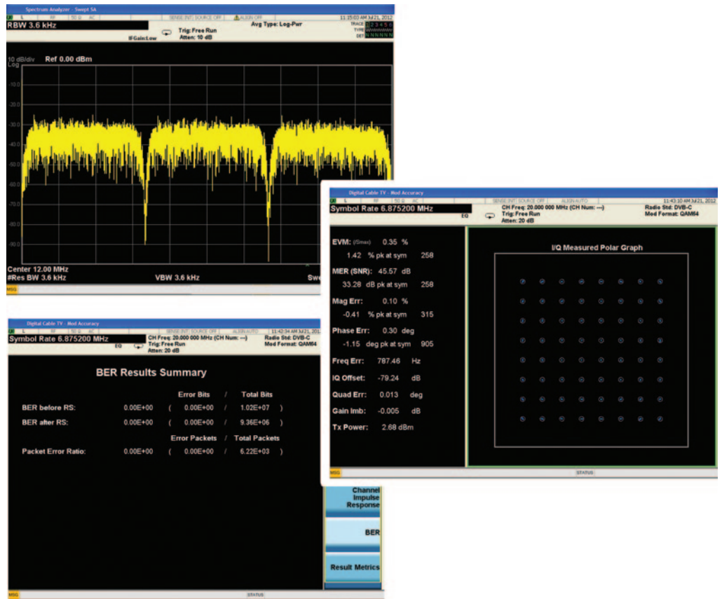
图 11. Keysight 33522B 同时生成 3 个 DVB-C 64QAM 载波。在中心信道中执行测试，所有信道根据 DVB-C 标准进行编码—但数据不能避免在合成信号中人为地出现大功率峰值。DVB-C 分析显示了所得的调制质量(EVM=0.35%)。由于信号已经过了恰当的信道编码，可用于执行 BER 测试。通过检测解码之前和之后的校正误差和未校正误差，可以计算出 BER。
