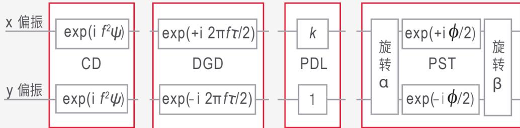
图 48. 用于补偿色散 (CD)、差分群时延 (DGD)、偏振相关损耗 (PDL) 和偏振态转换 (PST) 的均衡滤波器模型<sup>1</sup>
