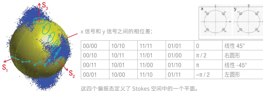
图 49. 偏振多路复用 (PDM) QPSK 信号的 Stokes 空间中的 Poincaré 球
