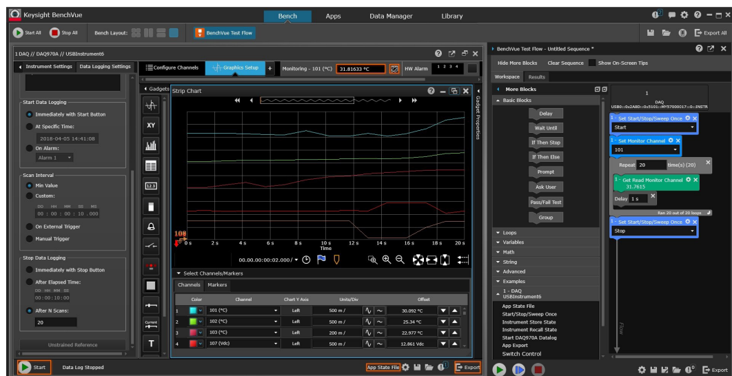
图 5. 在 PC 上运行的 BenchVue DAQ 应用软件可以实时进行数据采集、监测（趋势图）和记录
