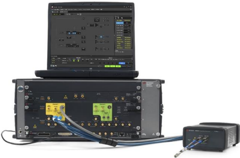
图 12: 配有 M8045A PG、M8046A ED 和 M8057A 远程前端的 M8040A BERT 系统
