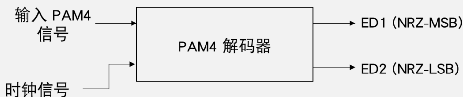
图8: PAM4 解码成两个 NRZ 流
