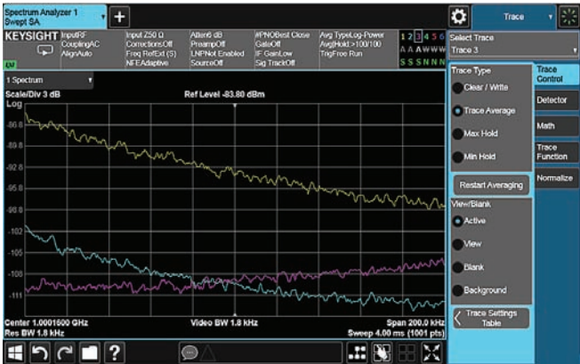
图 2-12b. 距载波频偏为 140 kHz 处的详细显示
