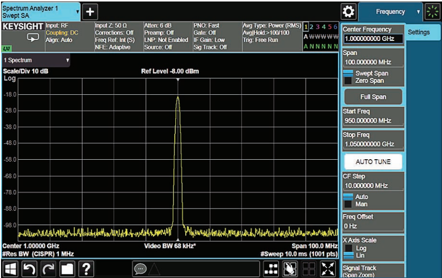
图 2-18. 1001 个迹线点（信号收集单元）中的每个点都覆盖了 100 kHz 的频率扫宽和 0.01 ms 的时间扫宽
