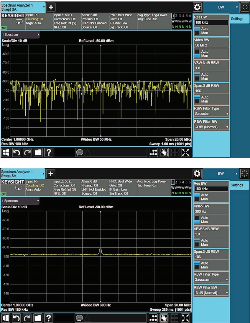
图 5-3. 视频滤波使得低电平信号更易分辨
