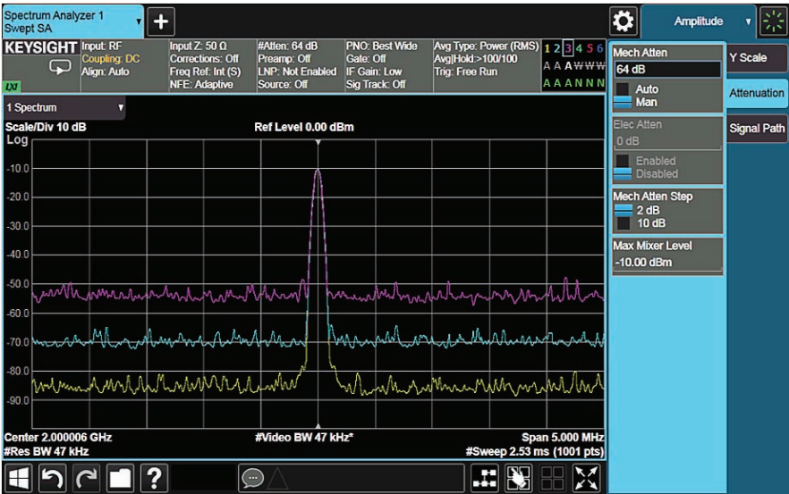
图 5-1. 在现代信号分析仪中, 改变输入衰减, 基准电平会保持不变
