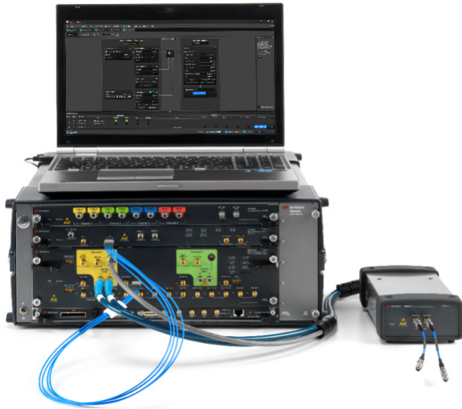
图 23. 使用 M8040A 64 Gbaud 高性能 BERT，获得准确且可重复的结果。
