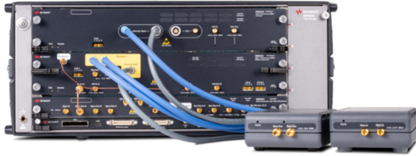
图 21. 使用 M8050A 可进行高达 120 Gbaud 的码型生成和误码分析。
