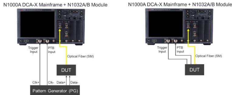
图 19. 适用于 64 Gbaud 以上信令速率的典型设置
