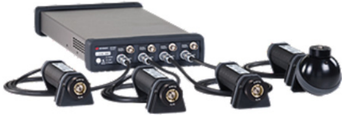
图 7. 用于 8162-C 远程功率计探头的 N7749C 接口
