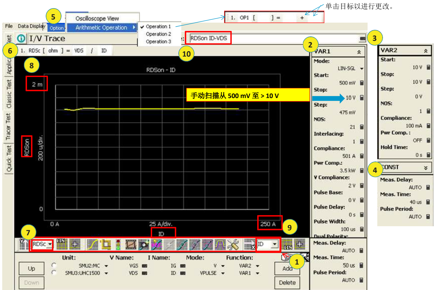
图 4-17. 设置 Rds ON - I_d 测试。
