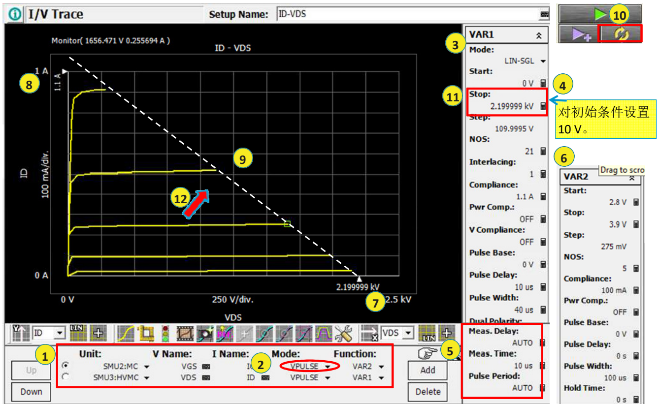
图 6-13. 使用 HVMCU 设置 2.2 kV 追踪仪测试。
