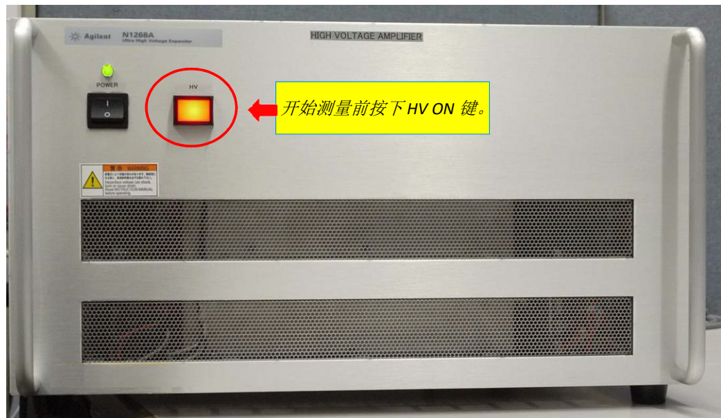
图 8-8. UHVU 激活时，HV 指示灯/按钮将亮起。
