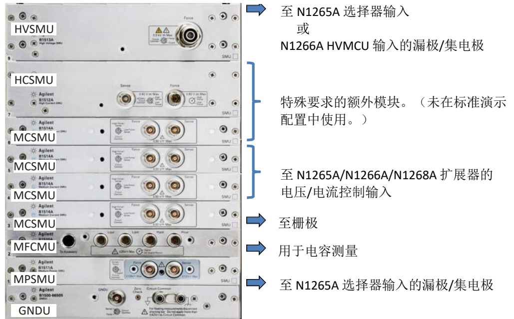
图 2-1. 示例中使用的 B1505A 配置。
