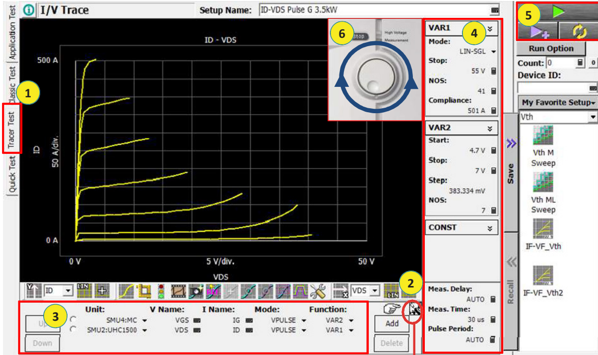
图 1-6. 追踪仪测试模式 GUI 示例。
