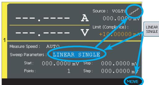
5. 使用旋钮、箭头键或数字 / 字母键并设置 Start (扫描启动值)、Stop (扫描停止值) 和 Step (扫描步进值) 或 Points (扫描步进数)。
