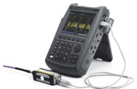
USB 功率传感器可以简化功率测量
