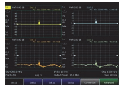
利用混合模式 S 参数测量来表征共模和差模反射
