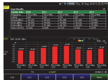
5G TF OTA 可测量控制信道并显示小区 ID
