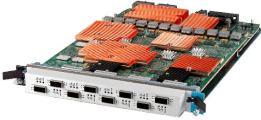
图 1. Novus 8 端口原生 QSFP28, 100/50/40/25/10GE 单插槽负载模块
