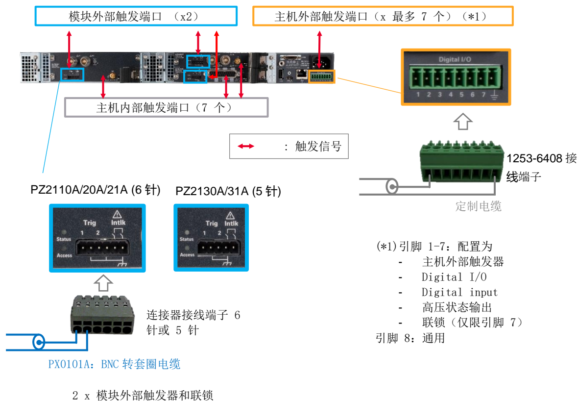
图 8. 主机和 SMU 上的触发端子
